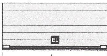
Länge der Endleiste = Torbreite + 40 mm
