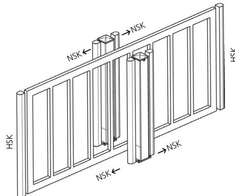
**Schließkanten und Eingriffsmöglichkeiten müssen so abgesichert sein, dass Personen- und Sachschäden ausgeschlossen werden können. Bei einem öffentlich zugänglichen Tor muss eine Lichtschranke verbaut werden (laut der DIN EN13241-1).**
