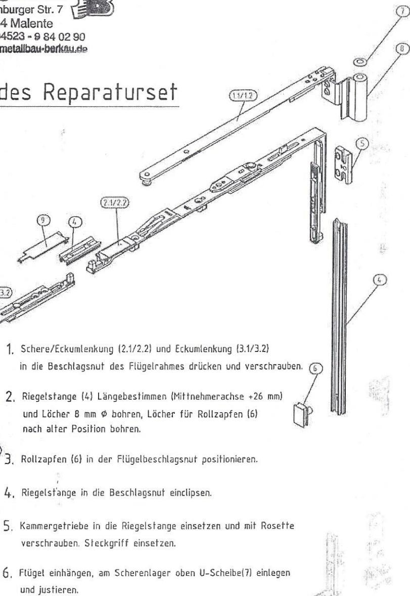
Ausgetauscht werden folgende Bauteile des vorhandenen RS-Beschlag
