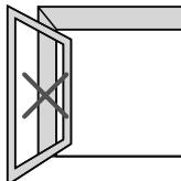
**Stellen Sie die Elementflügel nicht gegen Mauervorsprünge.**
