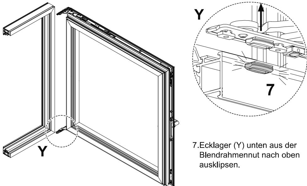
7. Ecklager (Y) unten aus der Blendrahmennut nach oben ausklipsen.
