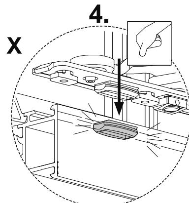
4.Ecklager (X) in die Blendrahmennut nach unten einklipsen und in die Ecke schieben.
