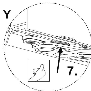
6.Flügel um Flügelachse schwenken und Scherenlager in die Richtung Blendrahmenecke einschieben.
