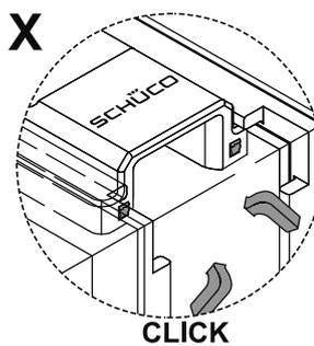
4. Fehlbedienungssperre der Eckumlenkung betätigen.
