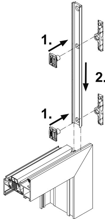
1. Schließrollen in Riegelstange stecken.
