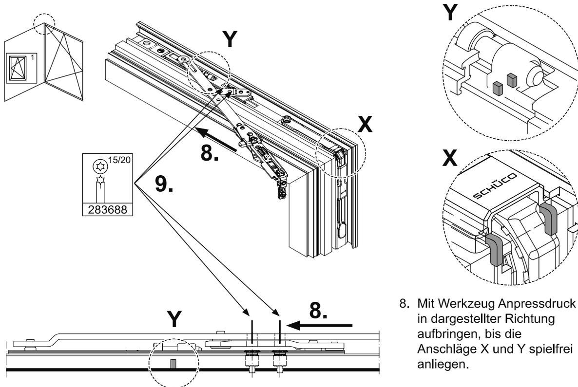
8. Mit Werkzeug Anpressdruck in dargestellter Richtung aufbringen, bis die Anschläge X und Y spielfrei anliegen.
