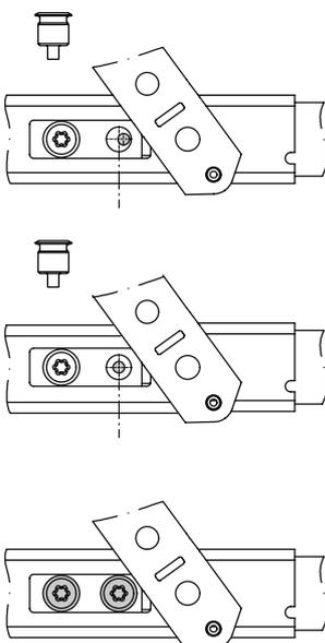
Falls die Schere im Reparaturfall montiert wird, müssen die Stanzschrauben zwingend wieder in die bereits vorhandenen Stanzlöcher eingesetzt werden.
