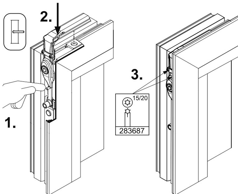
1. Griffseitige Eckumlenkung mit Sperre, in obere horizontale Riegelstange einkoppeln.
