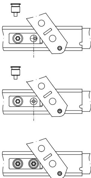
Falls die Schere im Reparaturfall montiert wird, müssen die Stanzschrauben zwingend wieder in die bereits vorhandenen Stanzlöcher eingesetzt werden.
