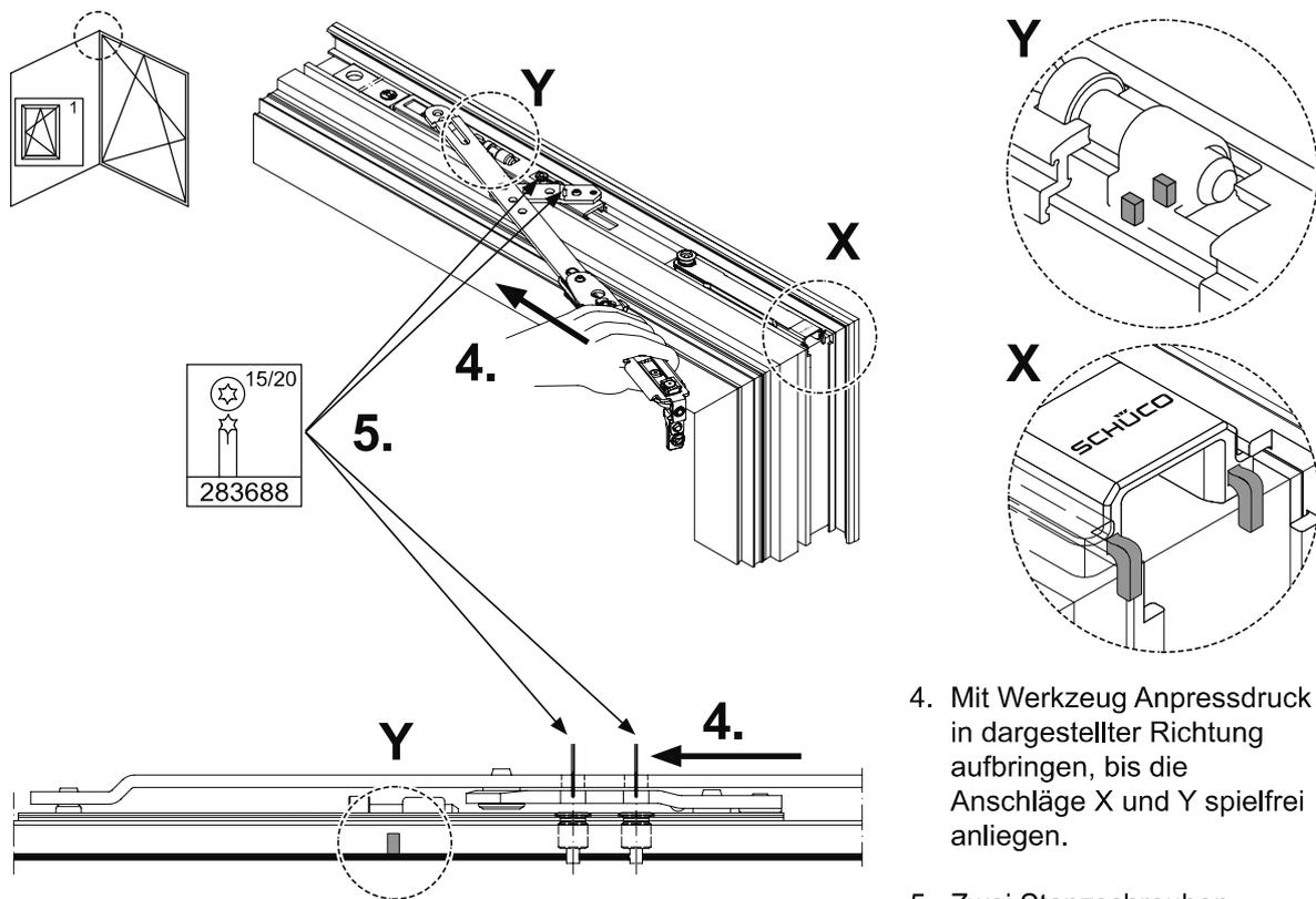
4. Mit Werkzeug Anpressdruck in dargestellter Richtung aufbringen, bis die Anschläge X und Y spielfrei anliegen.
