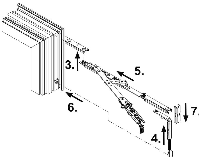
3. Schere mit der oberen Riegelstange koppeln.
