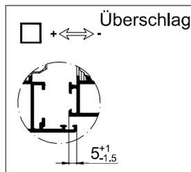
Bei Bedarf sind Flügelaufschlag und Flügelüberschlag zu kontrollieren und auf Maß einzustellen.
