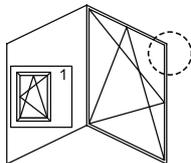
Bevor die Drehkipp Schere AvanTec demontiert werden kann, ist zuerst die griffseitige obere Eckumlenkung mit Sperre zu lösen.
